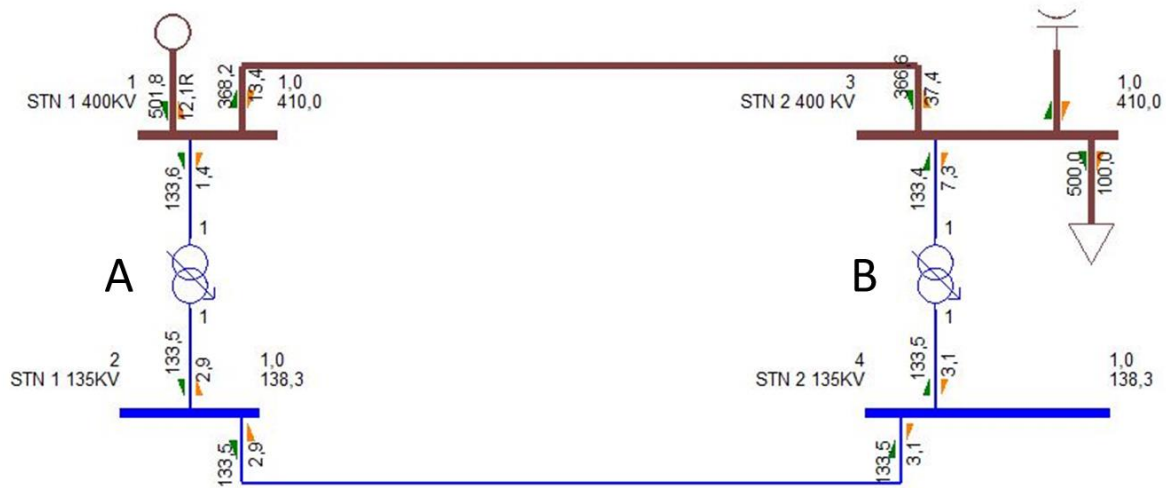
Figur 8. Konstruerad transiteringsmodell använd för att beskriva förluster i regionledning som funktion av ledningstyp och ledningslängd relativt överliggande stamnätsledning. Brun ledning representerar 400 kV och blå 130 kV.
