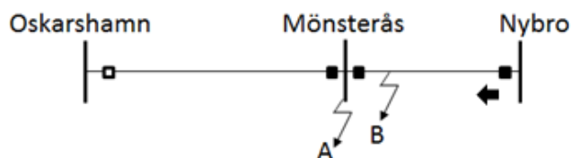
Figur 36. Fel fall behandlade för reläskyddet i Nybro. Brytaren är tillslagen vid ifylld ruta, frånslagen vid tom ruta.
