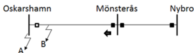
Figur 35. Felfall behandlade för reläskyddet i Mönsterås. Brytaren är tillslagen vid ifylld ruta, frånslagen vid tom ruta.
